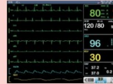
Maksimum 8 eşzamanlı dalgaboyu görüntüleme, maksimum 6 lead'li EKG dalgaformlu ekran
